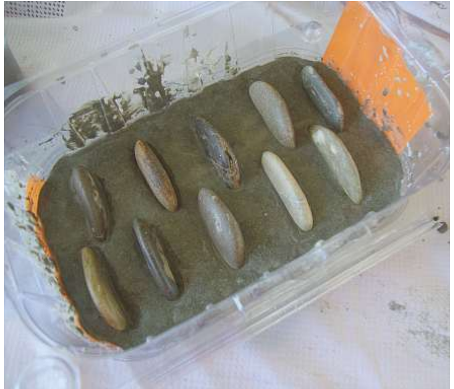
Luftblasen im Zement müssen durch gutes Durchrütteln vermieden werden. Fotos: zVg.
