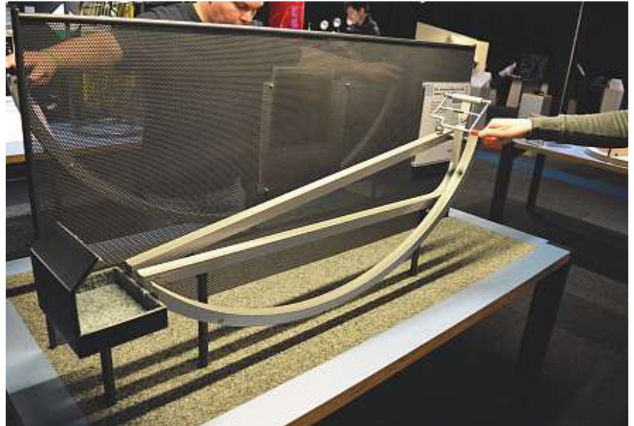
Welche Krümmung befördert die Kugel am schnellsten zum Ziel? Die Kugelbahn im Technorama zeigt eindrücklich: Der kürzeste Weg ist nicht immer der schnellste. Fotos: Irene Schertenleib.
